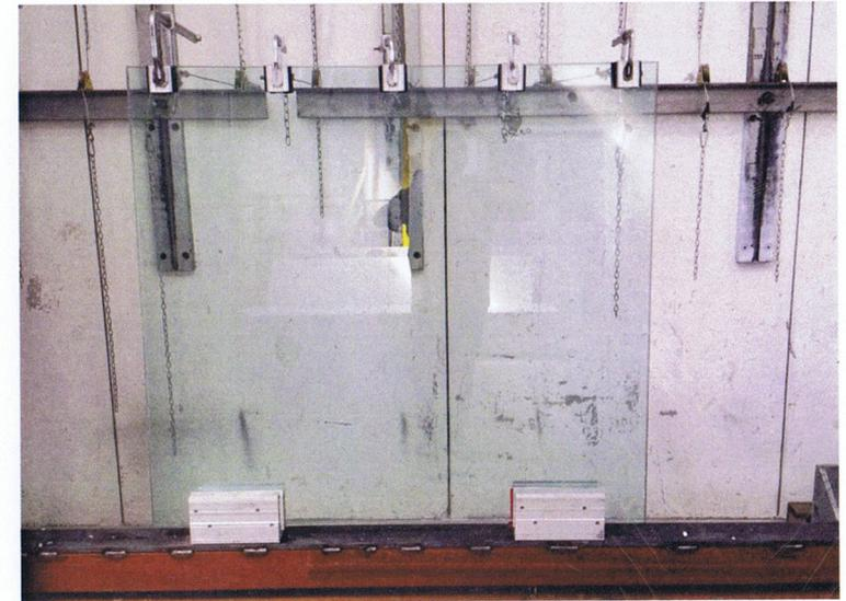
Test pour resistance au charge statique 2kN/m
